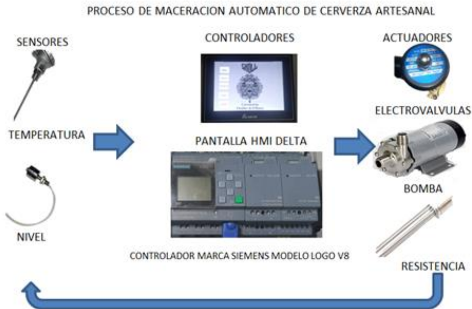
Figura 1: Proceso de maceración automático
