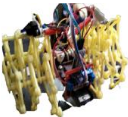
Figura 18. Robot hexápodo con estructura Theo Jansen Fuente: Elaboración Propia
