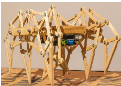
Figura 7. Estructura Theo Jansen para robot Fuente: (Narváez, 2004)
