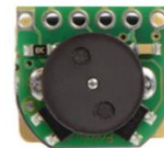
Fig. 10 Encoder magnético de cuadratura
