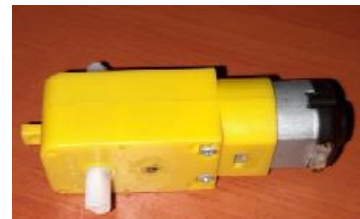
Figura 6. Micromotor con caja reductora plástica
