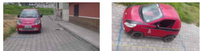
Figura 9 Prueba de distancia de frenado en adoquín
