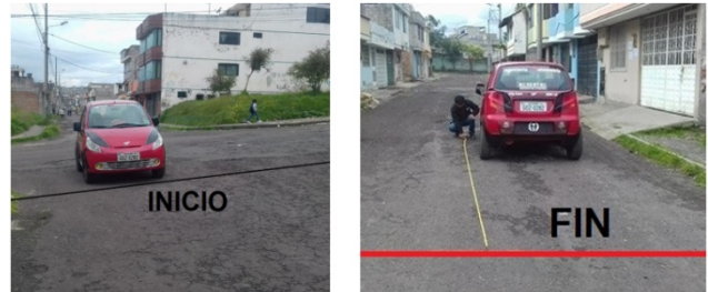
Figura 8 Prueba de distancia de frenado en asfalto
