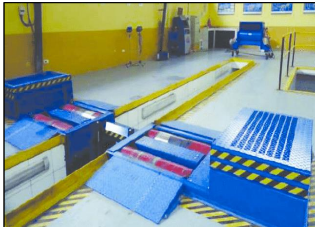
Figura 1: Banco dinamométrico LPS 3000 Fuente: Propia
