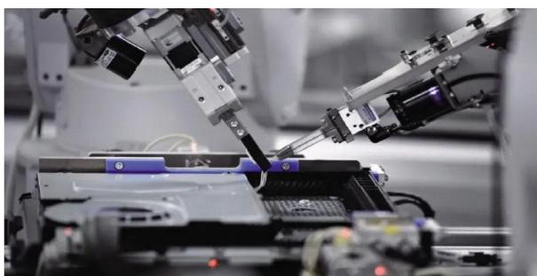
Gráfico5: Robots uniendo partes sensibles de la consola. Tomado de MuyComputer, 2020
