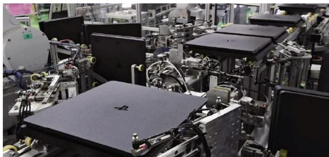
Gráfico4: Ensamblaje de los PS. Tomado de MuyComputer, 2020
