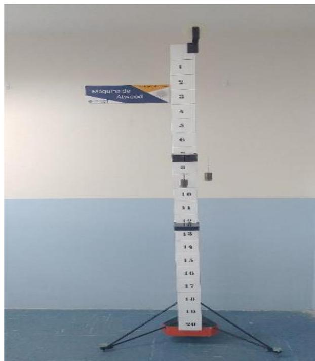
Figura 7: Máquina de Atwood construida en el laboratorio de Física de la Universidad Israel. Quito-Ecuador. Año 2019.
