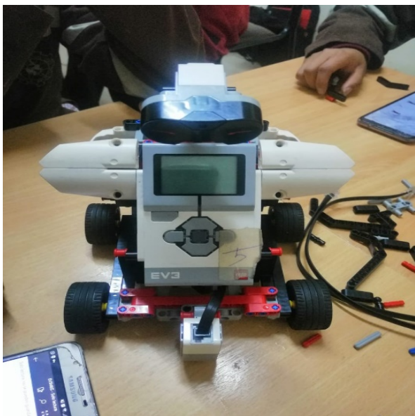
Fig. 2 Construcción final de un robot de cuatro ruedas con sensor infrarrojo, de color y motores.
